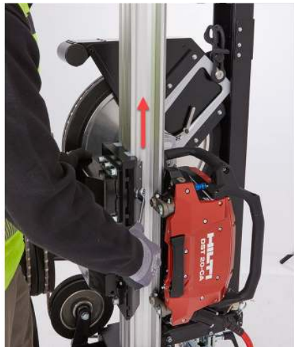
4. 拆下锯绳卷绕装置护罩。
