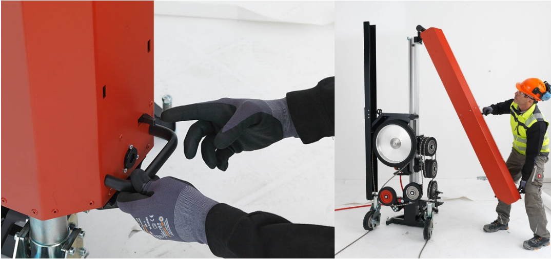
4. 拆下锯绳卷绕装置护罩。
