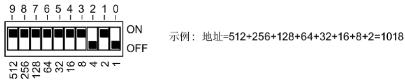
图 3-1 设置地址开关（DIP 开关）的示例
