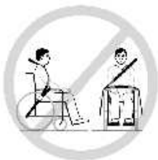
Figure 3a - Mauvais positionnement de la ceinture au niveau du bassin sur les supports du fauteuil roulant.
