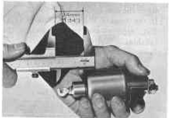
Fig. 9-18 Checking Moving Stud Length
